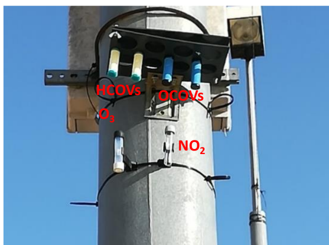
Figura 8. Dosímetros Gradko (para O 3 y NO 2 ) y Radiello (para COVs) instalados en un emplazamiento de medida.
